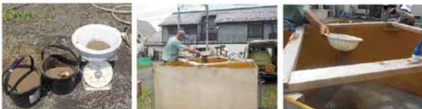
写真 2-14 目詰まり物質とその負荷状況(歩道部ケース I)
