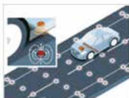
マグネットで、最大誤差10cm未満の目に見えない「道路」を作り出す。すでにさまざまな速度域でのテストが繰り返されている
